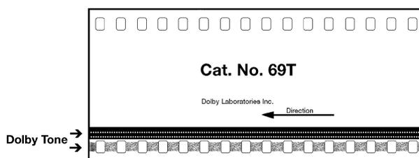
Ce film est nécessaire au bon entretien de votre système cinéma. Le Dolby Tone enregistré sur le film est utilisé pendant le réglage automatique du niveau dans le CP650. Cette procédure simple doit être effectuée à chaque changement de lampe excitatrice ou de LED, ainsi que régulièrement pour compenser leur vieillissement normal (qui provoque une baisse du niveau de sortie des pistes son analogiques).
