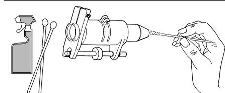
Utilisez un coton-tige et un produit à vitres pour nettoyer la surface des lentilles du tube optique.
